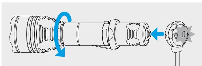
Закрутить голову фонаря до упора и подключить магнитное зарядное устройство к задней части фонаря.
